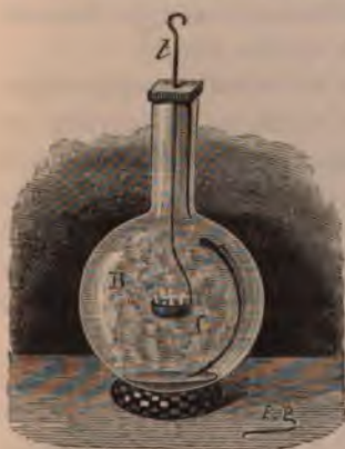
Fig. 10. Combustion du soufre dans l'oxygène.
